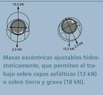
Masas excéntricas ajustables hidrostáticamente, que permiten el trabajo sobre capas asfálticas (13 kN) o sobre tierra y grava (18 kN).
